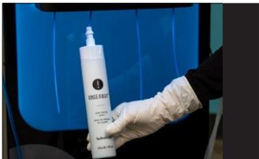
Lorsque le rinçage est terminé. Retirer la bouteille de solution de l'emplacement 1 et la raccorder à l'emplacement 2. Sélectionner continuer.
