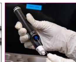
Insérer la brosse de nettoyage dans l'orifice d'aspiration (le plus petit) situé sur la face de la pièce à main. Pousser la brosse complètement vers l'intérieur et l'extérieur tout en tournant 3 fois. Répéter l'opération dans le connecteur bleu.
