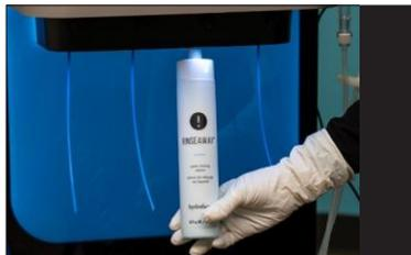
Lorsque le rinçage est terminé. Retirer la bouteille de solution de l'emplacement 2 et la raccorder à l'emplacement 3. Sélectionner continuer.
