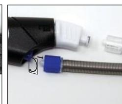
Détacher les tubulures de la pièce à main en tournant doucement dans le sens inverse des aiguilles d'une montre.
